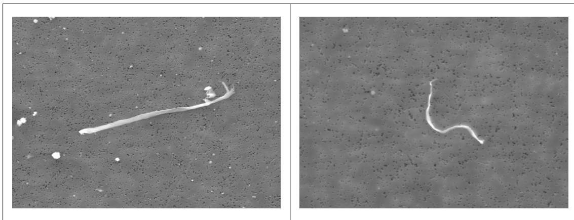
그림 2. 지하상가 중 섬유상 먼지(비석면) SEM 사진.
